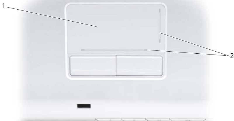
1 タッチパッド 2 スクロールの可動範囲を示すシルクスクリーン印刷
