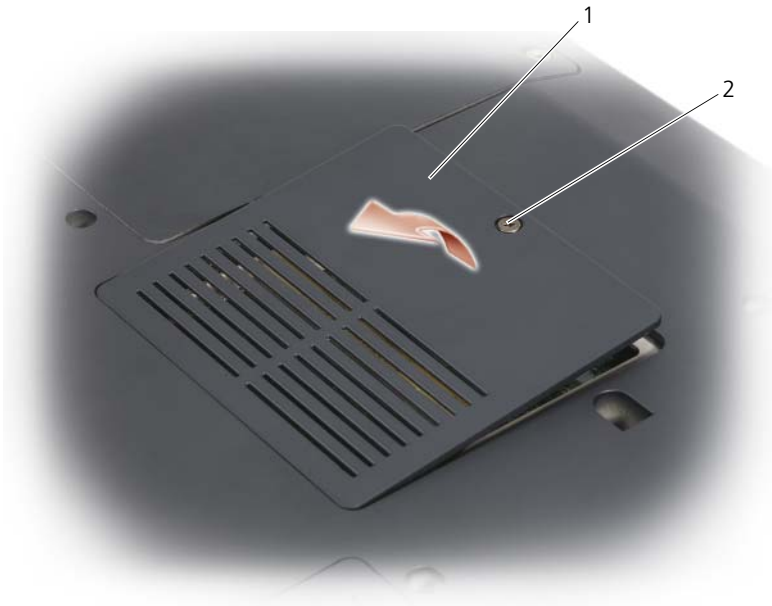
1 メモリモジュール/コイン型電池実装部 2 ネジ
